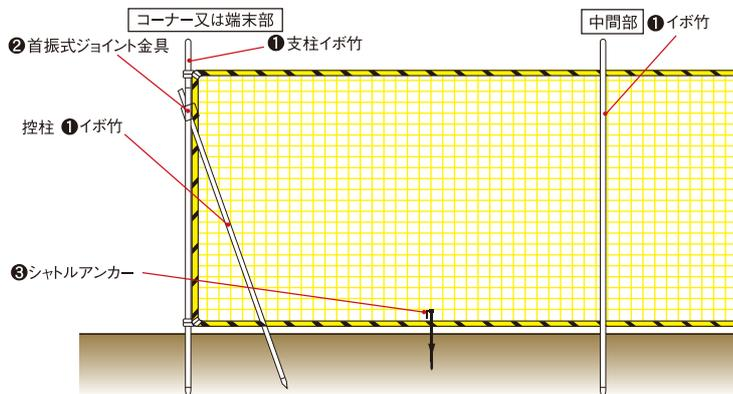
区画ネット施行補助器具(支柱)・控柱としてイボ竹(33mm×1.5m・33mm×2.1m)、控柱固定金具として首振式ジョイント金具・ロープ、押さえとしてシャトルアンカーもご用意しております。
