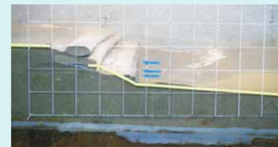
■水理模型実験 対象構造物：埋設護岸
